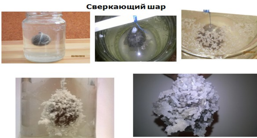
Приложение 2. Этапы выращивания кристалла «Сверкающий шар» из поваренной соли методом охлаждения насыщенного раствора.
