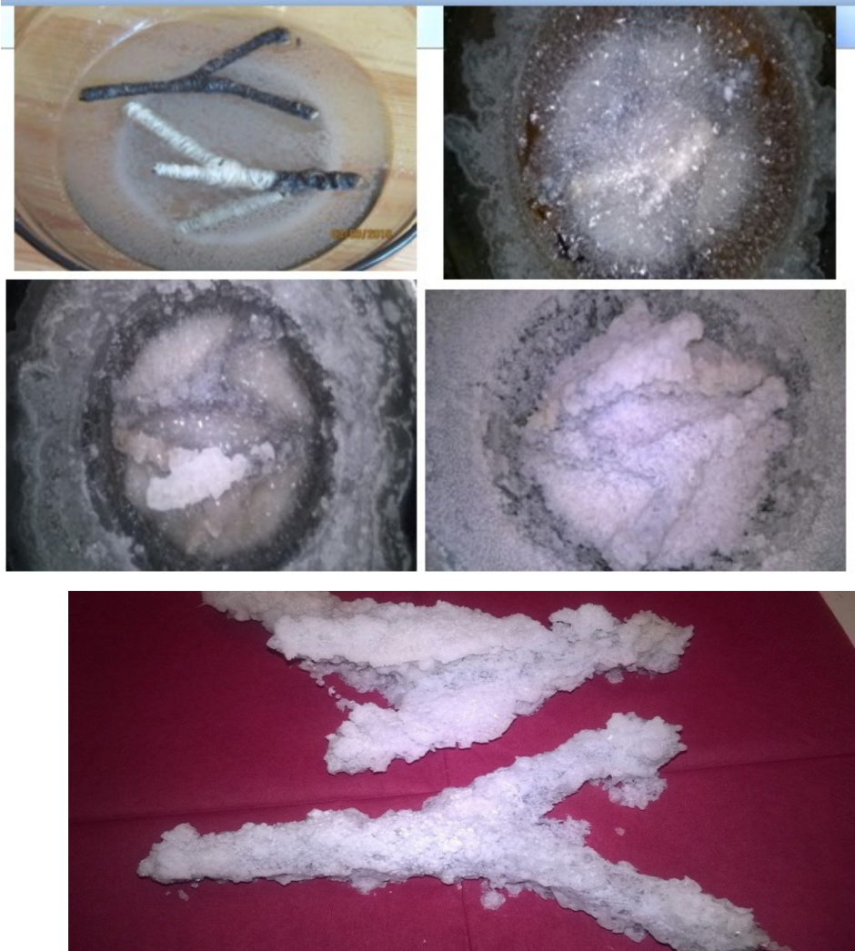
Приложение 2. Этапы выращивания кристалла «Сверкающий шар» из поваренной соли методом охлаждения насыщенного раствора.
